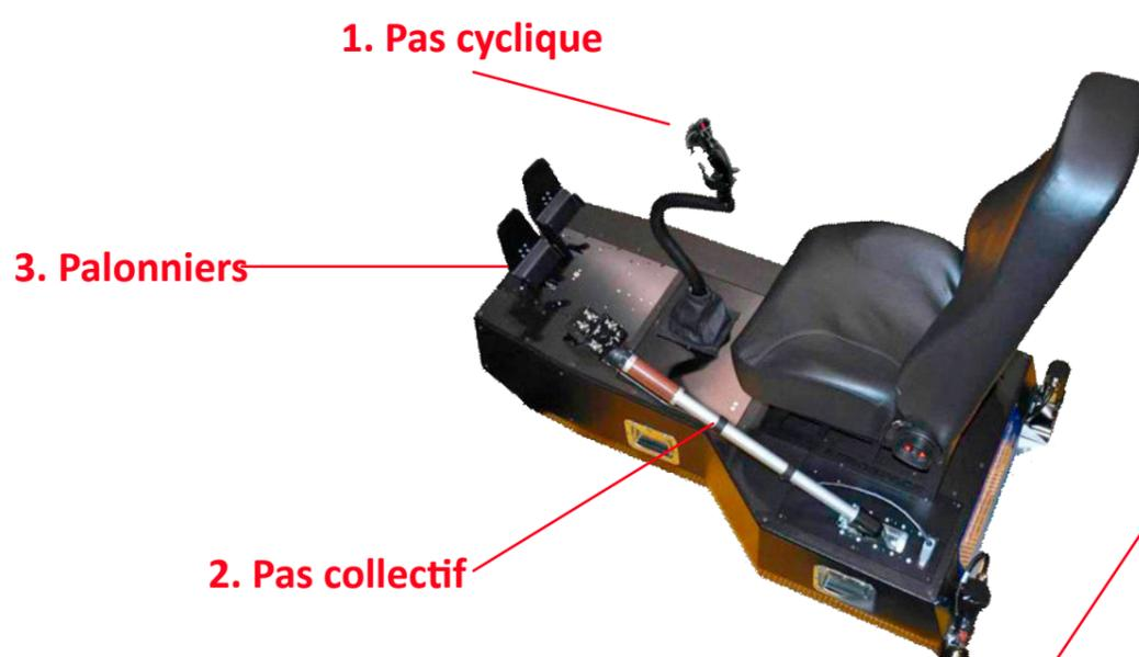
1. Le **pas cyclique** (manche) qui permet de basculer le disque du rotor principal dans n'importe quelle direction. En l'inclinant, l'hélicoptère avance, recule ou se déplace latéralement.
