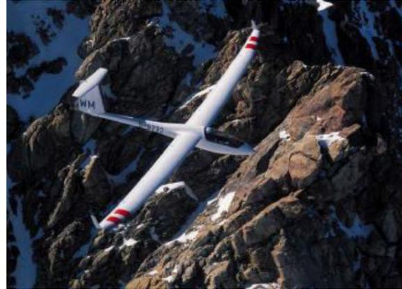
il se compose d'un plan fixe et de la gouverne de **profondeur**.
