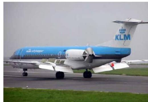
Ils permettent de voler à basse vitesse pour les besoins de l'atterrissage et du décollage. Pour maintenir la portance constante, la diminution de vitesse est compensée par une augmentation de la surface alaire et/ou une augmentation de la courbure (modification de CZ et CX).
