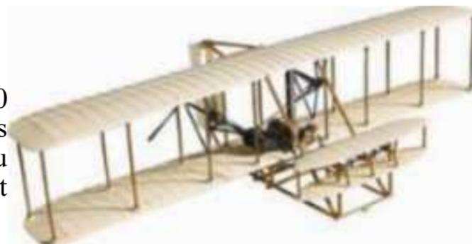
Ce premier avion construit par les frères Wright se nomme le Flyer (en français "La volante", du nom de leur marque de cycles), était un biplan "canard" de 12,35 m d'envergure, pèse 274 kg et est propulsé par un moteur de 16 CV qui actionne deux hélices, grâce à des chaînes de vélo. Ce premier vol homologué d'une durée de 59 secondes s'effectue à 3 mètres de hauteur sur une longueur de 260 mètres.
