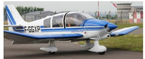
Sur ces deux types de trains, des freins sont montés sur les roues principales (train principal). Les efforts liés au roulage ou à l'atterrissage sont absorbés par des amortisseurs oléopneumatique, mécanique ou constitués de lames métalliques.
