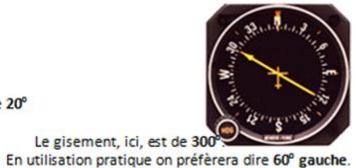
Pour plus de confort et afin d'éviter un calcul à effectuer lors d'une navigation, la rose est mobile. Si on affiche le cap magnétique suivi à la place du 0, l'indication de l'aiguille sur l'instrument fournit l'information du cap à prendre pour rejoindre la station au sol, donc directement le relèvement magnétique de la station par rapport à l'aéronef (QDM).
