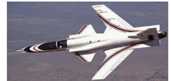
Trapézoïdale en flèche inversée (Grumman X29)
