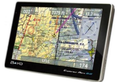
Précision horizontale de 100 à 300 m, verticale de 150 m mais pas d'intégrité c'est à dire pas de capacité du système à fournir une alarme en cas de défaillance.
