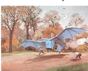
**9 octobre 1890** : **CLEMENT ADER** fait voler l' EOLE : 14 m d'envergure, forme de chauve-souris, moteur à vapeur, hélice tractive à quatre pales, 300 kg. Vol sur # 50 m non homologué.
