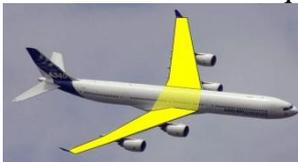
Trapézoïdale en flèche
