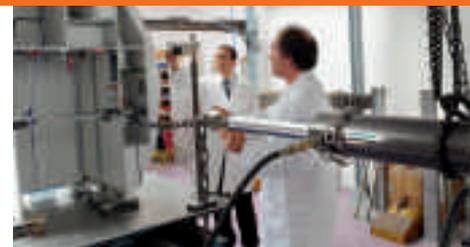
*Essai mécanique de qualification sur meuble pour cabine aéronautique*
